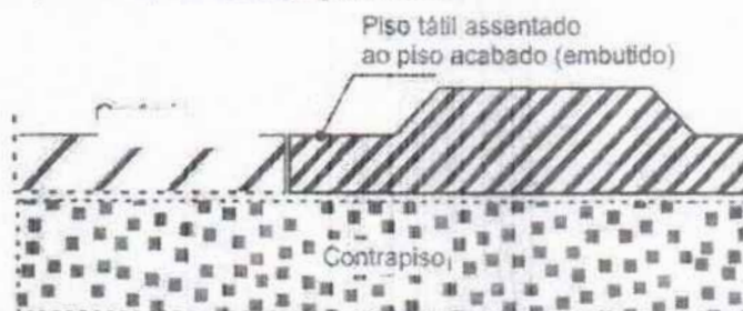
Figura 18 – imagem exemplificativa do assentamento de piso tátil de concreto. Fonte: wrstatil.com.br/produto/piso-tatil .
